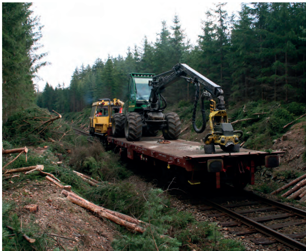
Obr. 31 Umístění harvestoru na plošinovém vozu
