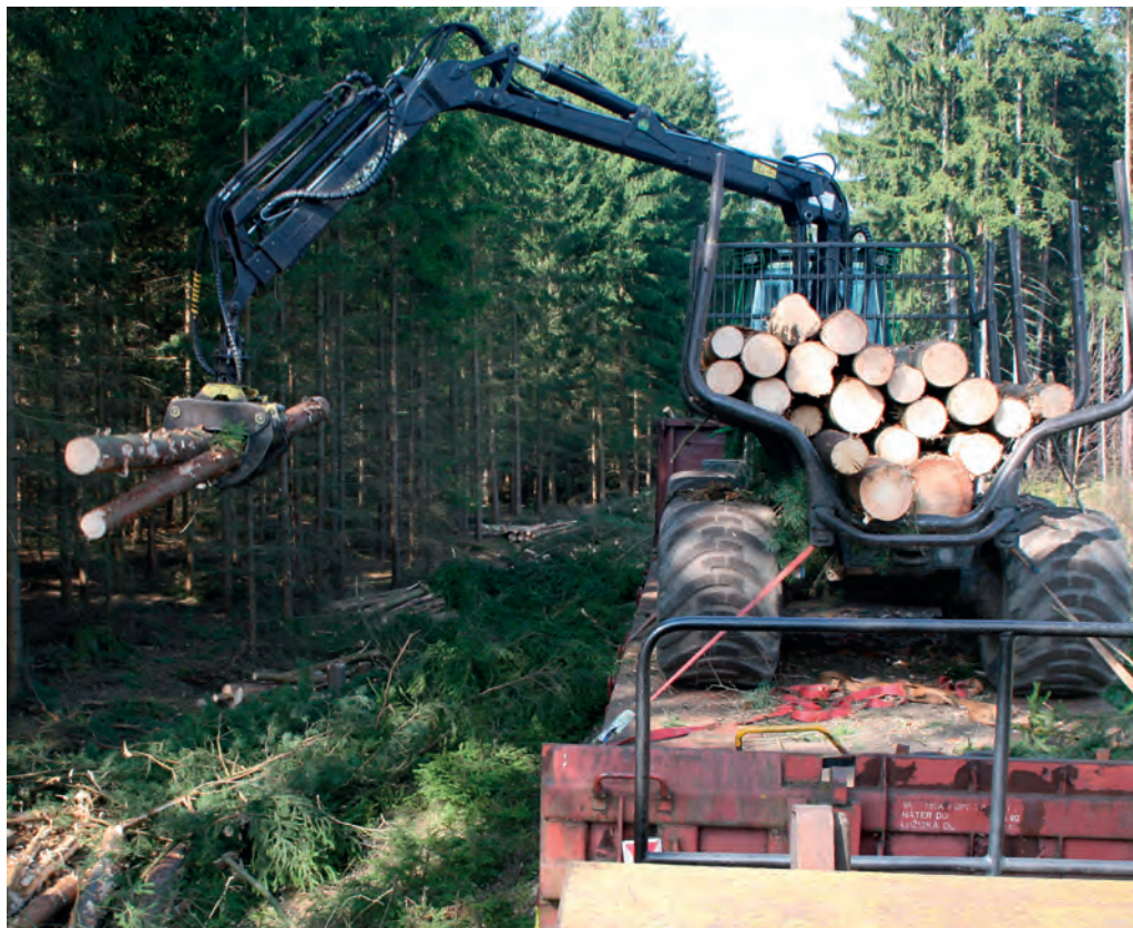
Obr. 32 Umístění vyvážecího traktoru na železničním vozu
