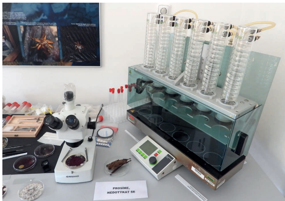
Obr. 60: Vlevo je vystavena preparační binokulární lupa s příslušenstvím a biologickým materiálem na Petriho miskách používaná k výzkumu kostí a zubů drobných obratlovců, hmyzu a jeskynních korýšů. Vpravo je umístěn extraktor tuků (foto I. Pavlík).
