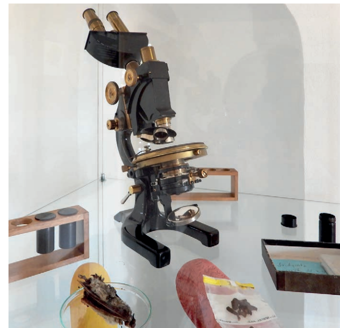
Obr. 64: Historický světelný mikroskop z přelomu 19. a 20. století s přirozeným zdrojem světla přiváděného do mikroskopu prostřednictvím polohovatelného zrcátka pod pracovním stolem mikroskopu (foto I. Pavlík).
