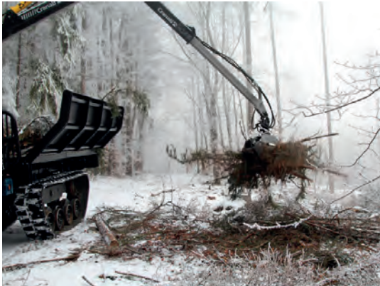
Obr. 53 Nakládání, převoz a skládání dendromasy variantou vyvážecího traktoru LVS 511 se svěrnými bočnicemi
