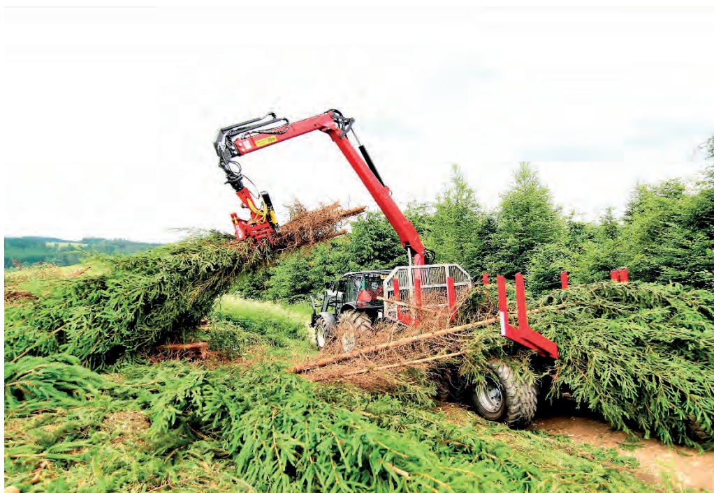
Obr. 48 Těžba a vyvážení dendromasy z prořezávek stromovou technologií – výsledkem čistá energetická štěpka s optimální vlhkostí pro spalovny nebo kompostárny
