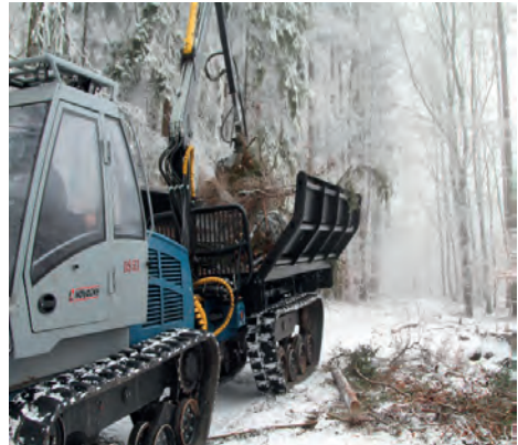
Obr. 53 Nakládání, převoz a skládání dendromasy variantou vyvážecího traktoru LVS 511 se svěrnými bočnicemi
