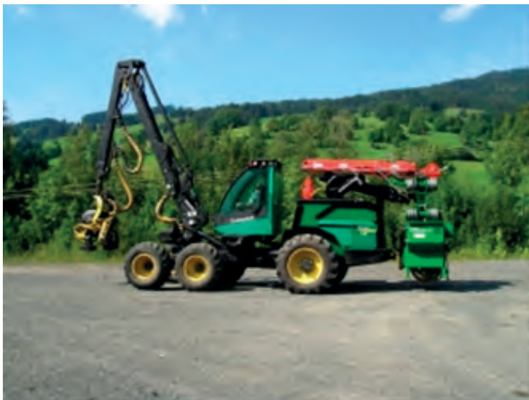
Obr. 65 Stožár lanovky jako nástavba na harvestoru
