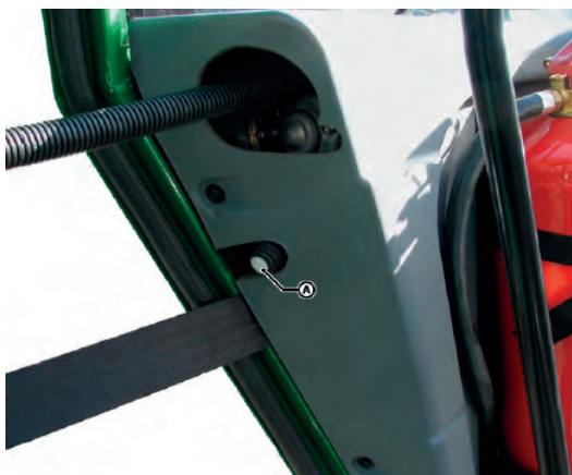
Obr. 41 Bezpečnostní spínač dveří
