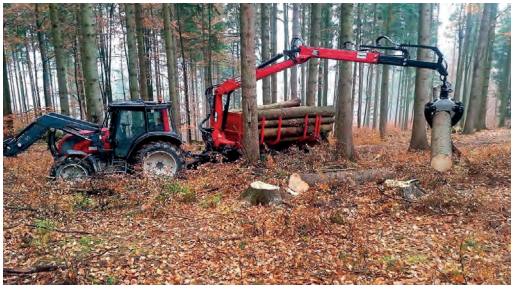
Obr. 48 Těžba a vyvážení dendromasy z prořezávek stromovou technologií – výsledkem čistá energetická štěpka s optimální vlhkostí pro spalovny nebo kompostárny
