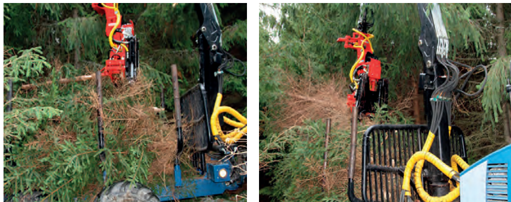
Obr. 54 Těžba dříví strižnou hlavicí na vyvážecím traktoru LVS 511
