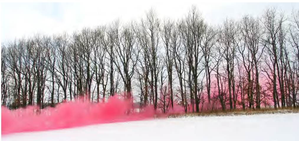
Obr. 34 Analýza změn přízemního proudění vzduchu vlivem drsnosti povrchu a překážek v terénu pomocí kouřové vlečky
