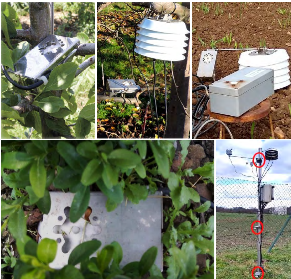
Obr. 14 Zařízení na měření ovlhčení listu umístěné v různých zemědělských kulturách Zdroj: autoři
