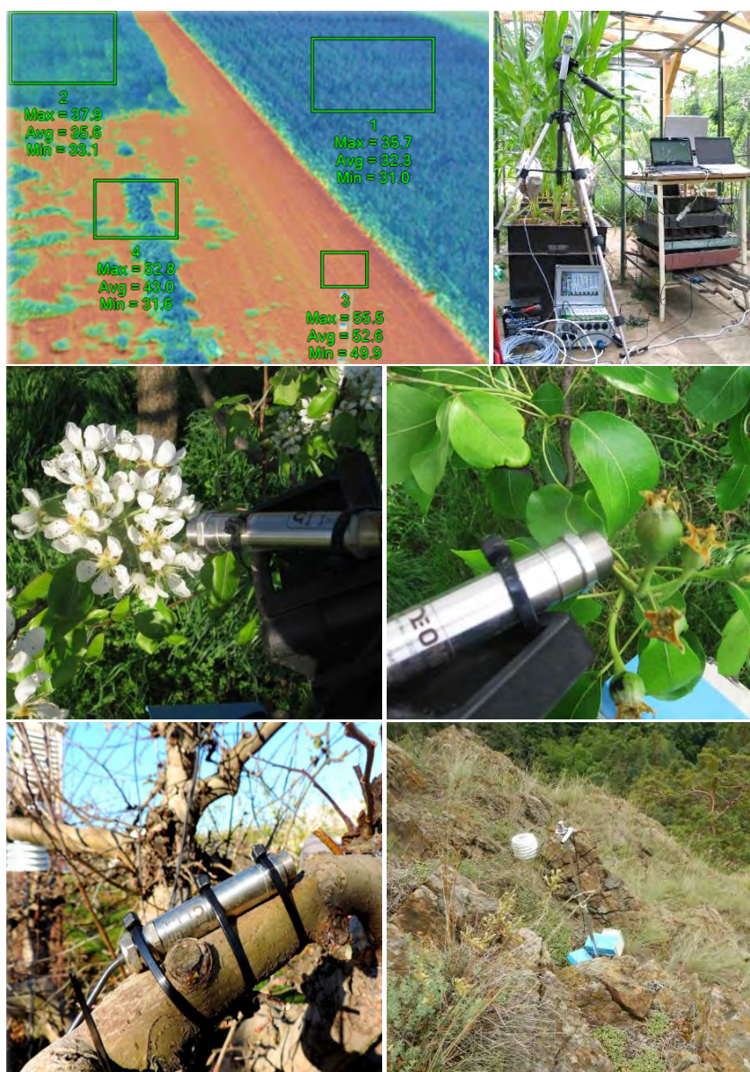
Obr. 22 Monitoring teploty povrchů v biologických experimentech použitím techniky různé konstrukce; povrchová teplota heterogenního povrchu pole s různými plodinami – termosnímek pořízený termální kamerou (nahore vlevo); měření povrchové teploty listů kukuřice infračerveným bezdotykovým termometrem (nahore vpravo); dlouhodobé měření povrchové teploty rostlinných pletí infračerveným bezdotykovým teploměrem (uprostřed vlevo měření teploty květů, uprostřed vpravo měření teploty plodů, dole vlevo měření teploty povrchu kůry ovocného stromu); dlouhodobé měření povrchové teploty přírodních povrchů v přírodně cenném prostředí (dole vpravo)
