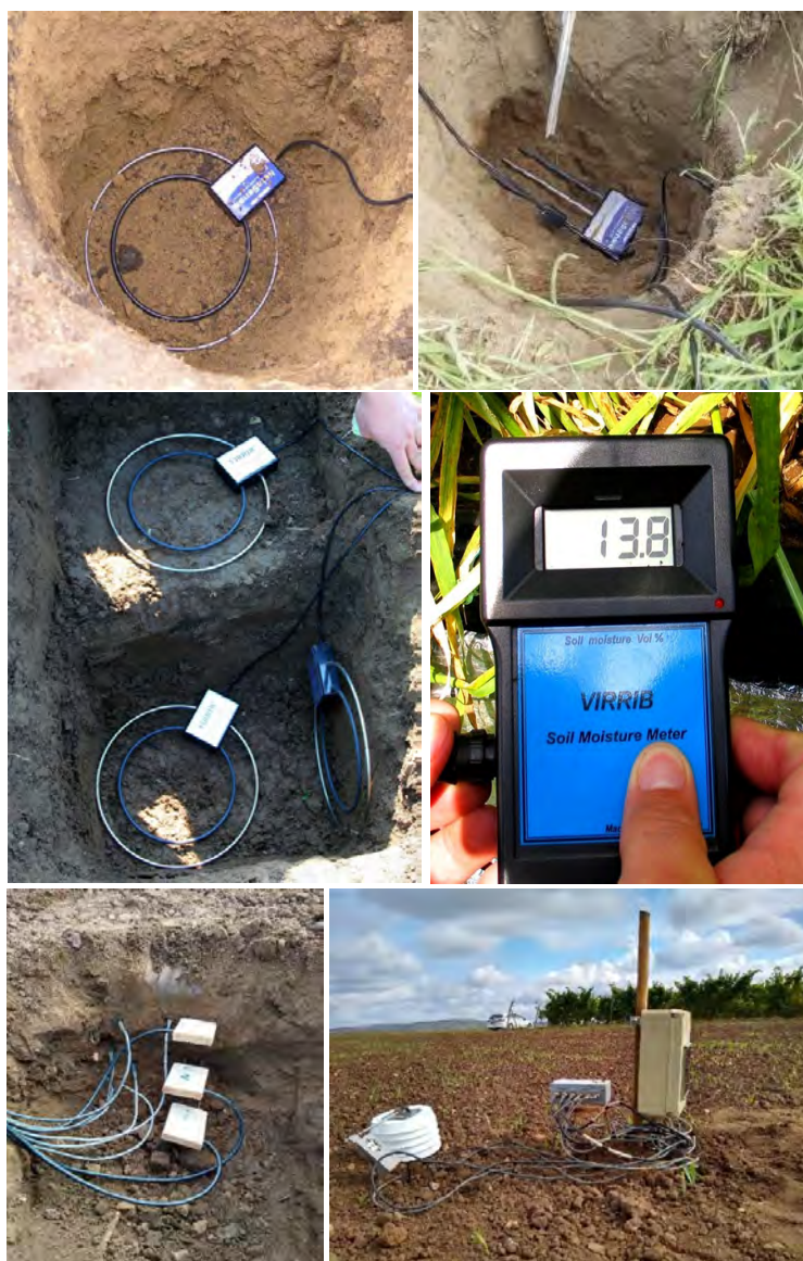
Obr. 8 Vodorovné umístění snímačů pro monitoring půdní vlhkosti – čidlo VIRRIB (snímek vlevo nahoře); vodorovné umístění snímačů pro monitoring půdní vlhkosti – čidlo VIRRIB – minimalizovaný typ (snímek vpravo nahoře); kombinace svislého a vodorovného umístění snímačů vlhkosti půdy VIRRIB (snímek vlevo uprostřed); manuální odečet údajů snímačů VIRRIB (snímek vpravo uprostřed); na dolním levém snímku: čidlo na měření půdní vlhkosti CS650 – vodorovně zasunutě břity (s bílou vyhodnocovací jednotkou) v pravé části snímku, půdní teploměry v levé části snímku; na dolním pravém snímku: ústředny senzorů VIRRIB a čidel CS650 s rozhraním pro odečet dat prostřednictvím kabelu a notebooku, případně s možností dálkového přenosu dat
