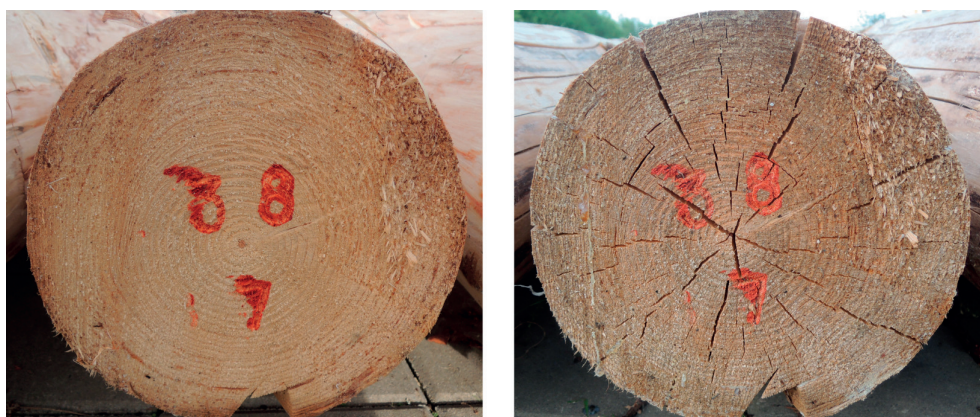
Obr. 4.10: Letní těžba: A – čelo oloupané kulatiny po kácení, B – čelo oloupané kulatiny po 1. roce přirozeného stárnutí
