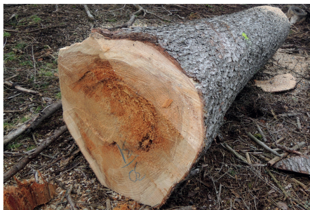
Obr. 3.22: Hniloba na příčném řezu
