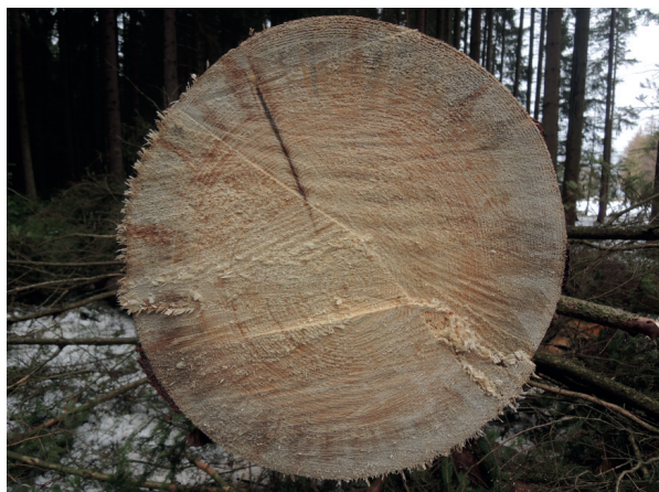
Obr. 3.21: Zamodráání běle na příčném řezu
