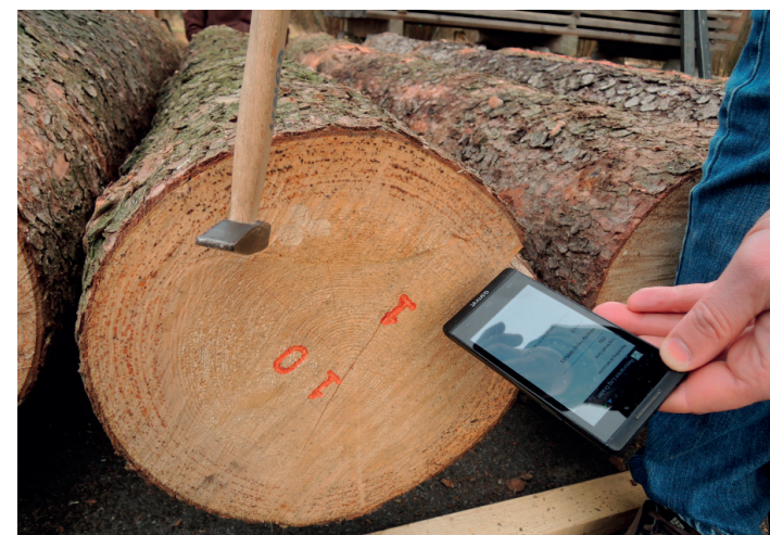
Obr. 3.25: Buzení zvukové vlny pomocí kladívka a analýza pomocí mikrofonu mobilního telefonu
