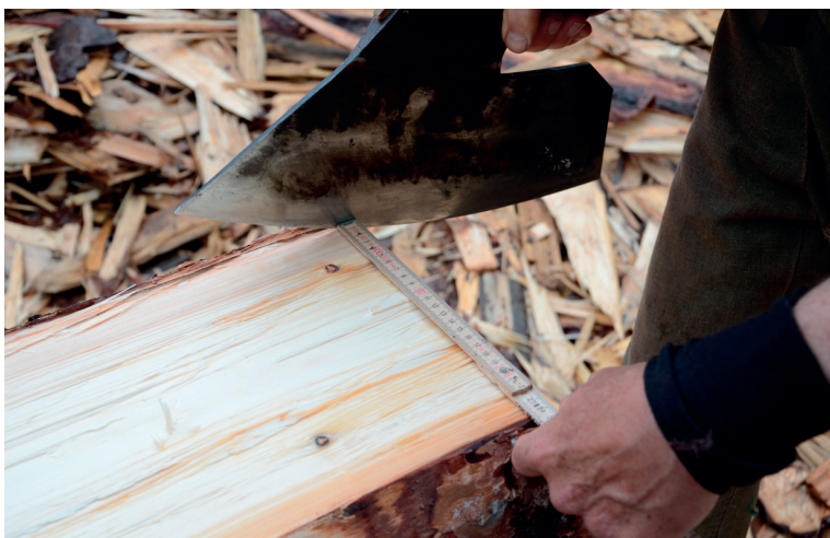
Obr. 5.3.4: Zářezy pro zachycení šňůry
