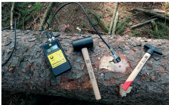
Obr. 3.24: Přístroj Fakopp 2D pro měření rychlosti šíření zvukové vlny mezi senzory
