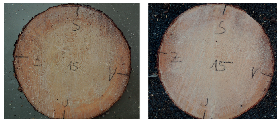
Obr. 4.3: Jarní těžba: A – po kácení, 3. května, vlhkost dřeva (běl 132%, jádro 32%), B – po 1. měsíci ve větvích, 29. května, vlhkost dřeva (běl 115%, jádro 32%)
