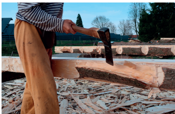
Obr. 5.3.19: Pravák couvá při hrubování u horní hrany levotočivé kulatiny
