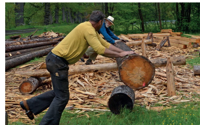
Obr. 5.2.2: Navalovací kozy – proces navalování nad přední nohy
