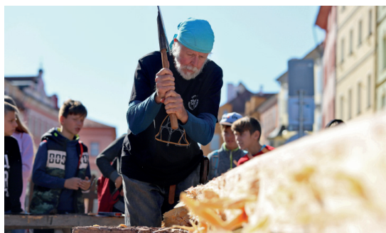
Obr. 5.3.22: Úder širočinou je veden po svislici v rozsahu odklonu do cca 3° ven
