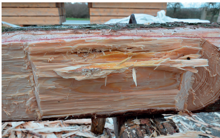
Obr. 3.20: Zárůst, který se objevil až při opracování dřeva
