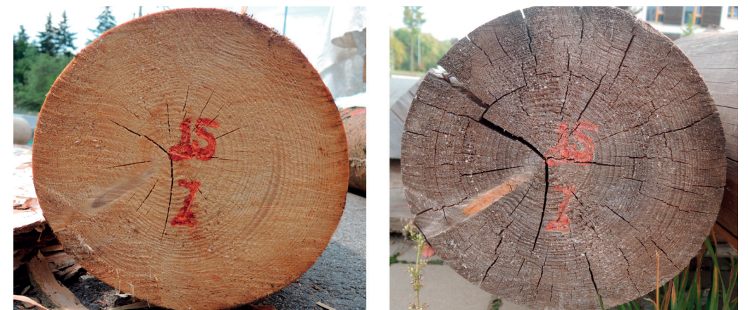
Obr. 4.8: Jarní těžba: A – čelo oloupané kulatiny po kácení, B – čelo oloupané kulatiny po 1. roce přirozeného stárnutí
