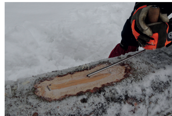
Obr. 3.10: Zjišťování točitosti kmene smrku pomocí črtáku
