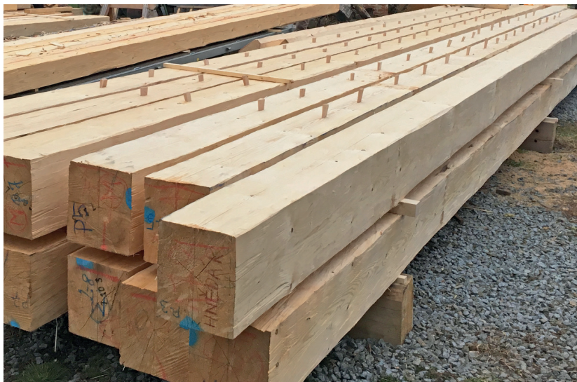
Obr. 6.8: Uložení tesaných trámů iniciovanou trhlinou směrem nahoru
