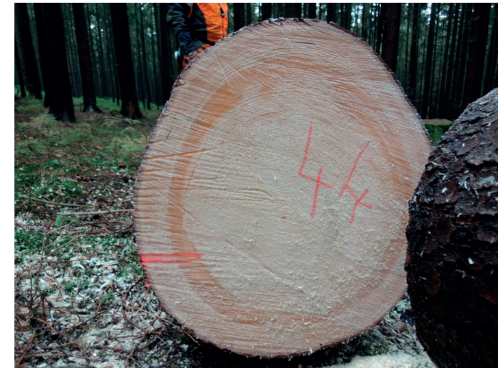
Obr. 3.16: Oválný tvar kmene na příčném řezu, „zploštění“
