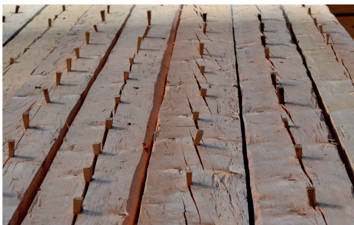
Obr. 6.5: Iniciování výsušné trhliny pomocí dřevěných klínků
