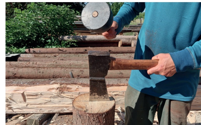
Obr. 5.4.25 Štípání na stojato pomocí sekery
