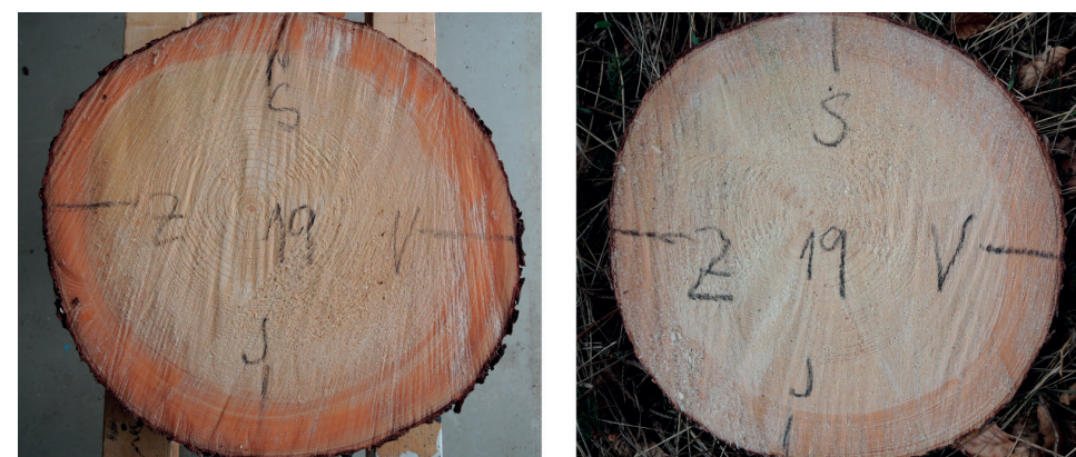
Obr. 4.2: Zimní těžba: A – po kácení, 3. února, vlhkost dřeva (běl 147%, jádro 31%), B – po 1. měsíci ve větvích, 3. března, vlhkost dřeva (běl 147%, jádro 30%)
