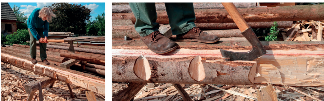
Obr. 5.3.2: Hrubování při postoji na kulatině
