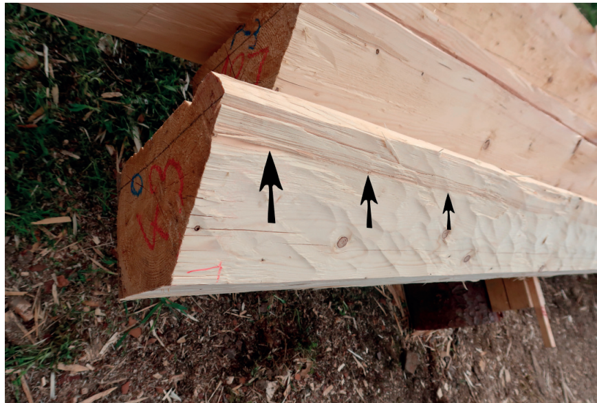
Obr. 3.18: Tlakové dřevo na podélném řezu
