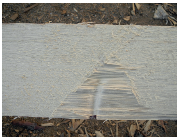
Obr. 5.5.10 Kínové nedořezy po rozštípnutí
