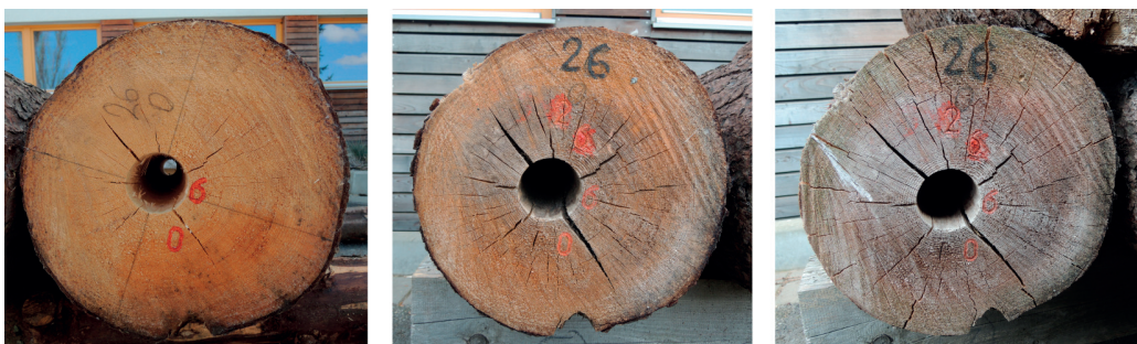
Obr. 4.13: Smrková kulatina s navrtaným středem: A – čelo po těžbě a navrtání, B – čelo po 1 roce přirozeného vysychání, C – čelo po 2 letech přirozeného vysychání
