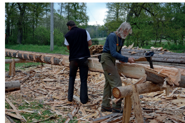
Obr. 5.3.17: Párové hrubování, kdy tesaři jdou na stejné straně kulatiny od středu směrem k čelům
