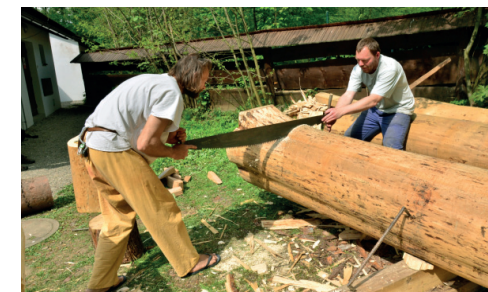
Obr. 5.4.2 Krácení na požadovanou délku prvku
