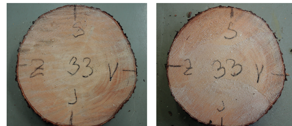
Obr. 4.4: Letní těžba: A – po kácení, 29. srpna, vlhkost dřeva (běl 117%, jádro 36%), B – po 1. měsíci ve větvích, 2. října, vlhkost dřeva (běl 126%, jádro 33%)
