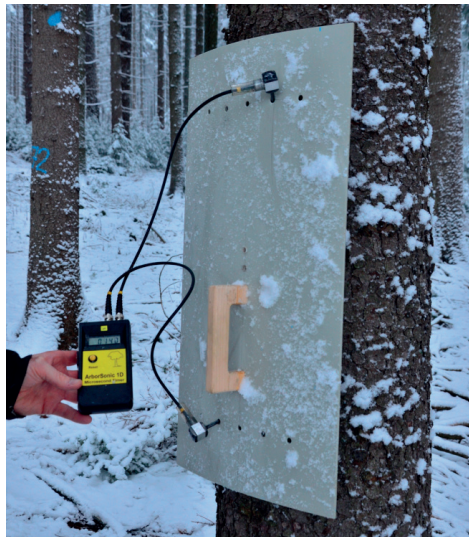
Obr. 3.11: Zjišťování točitosti kmene smrku pomocí přístroje pro měření času šíření elastické vlny. Pravotočivá konfigurace snímačů
