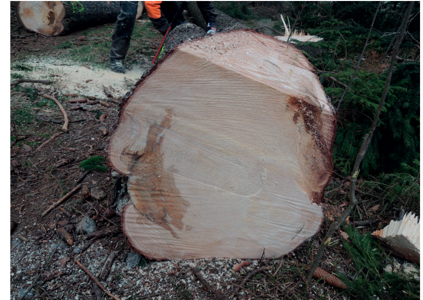
Obr. 3.19: Zásušek na příčném řezu kulatinou
