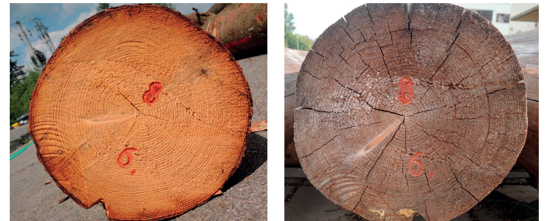
Obr. 4.7: Jarní těžba: A – čelo oloupané kulatiny po kácení, B – čelo oloupané kulatiny po 1. roce přirozeného stárnutí
