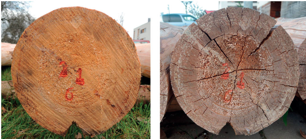
Obr. 4.6: Zimní těžba: A – čelo oloupané kulatiny po kácení, B – čelo oloupané kulatiny po 1. roce přirozeného stárnutí
