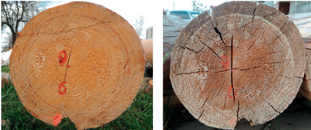
Obr. 4.5: Zimní těžba: A – čelo oloupané kulatiny po kácení, B – čelo oloupané kulatiny po 1. roce přirozeného stárnutí
