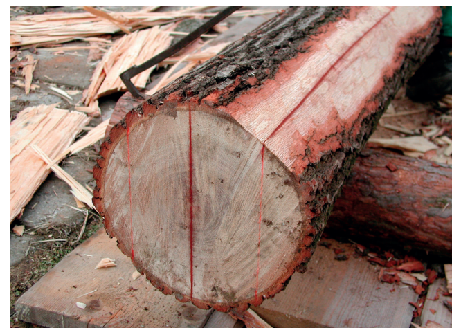
Obr. 5.3.5: Vyznačená linka na kulatině označující místo opracování
