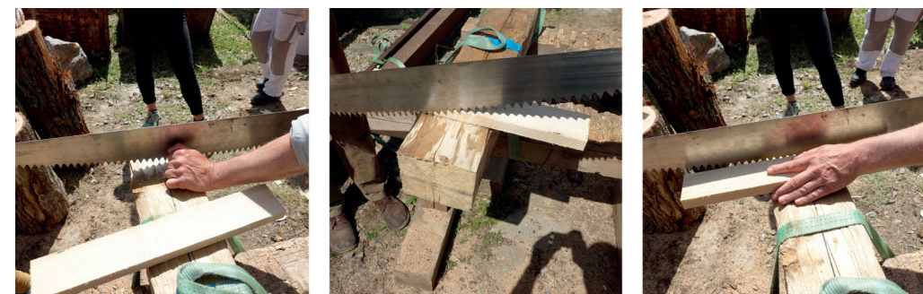
Obr. 5.5.8 Nařezávání horní plochy při příčném řezání
