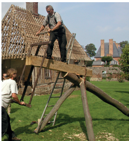
Obr. 5.5.7 Podélné řezání na trojnohé koze
