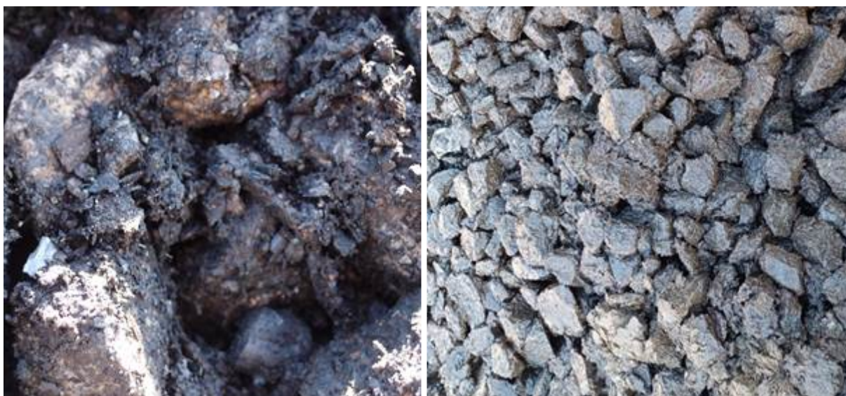
Obr. 24: Homogenně namíchaná směs strukturálního substrátu vyžaduje dostatečné namočení nosného kameniva.
