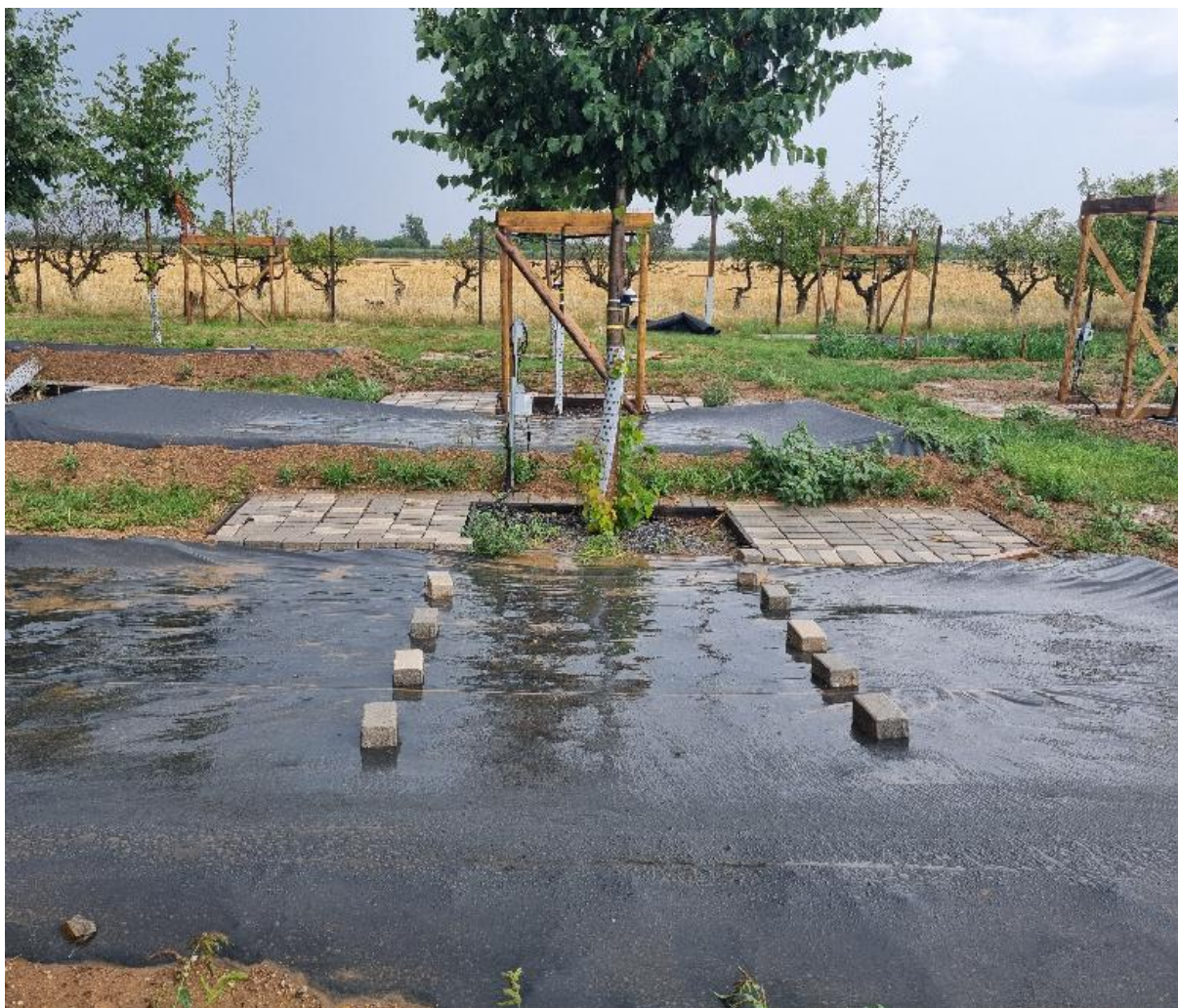
Obr. 36: Snímek připojeného povodí o ploše 20 m 2 za deště u pokusu na ploše CMZI v Tis-micích.
