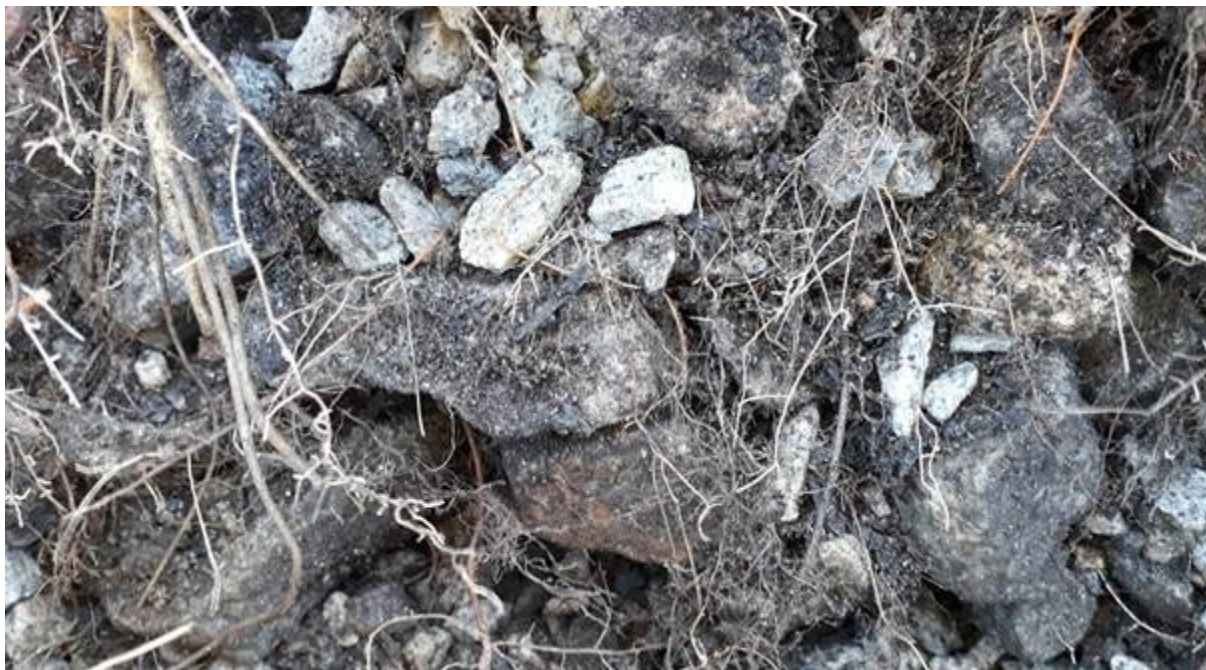
Obr. 23: Vývoj kořenů ve strukturálním substrátu
