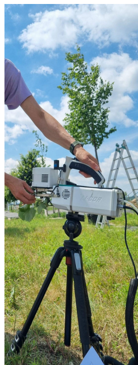
Obr. 42: Měření fotosyntézy infračerveným analyzátelem plynů LiCor LI-6800 na listech lip v Tismicích.
