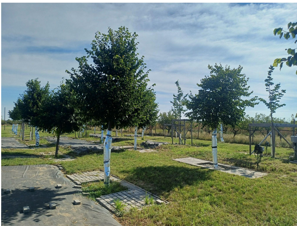
Obr. 47: Vizuálně patrný rozdíl ve vývoji vitality u stromu s připojeným povodím - st. explorace (vlevo) a bez povodí - st. degenerace (vpravo)
